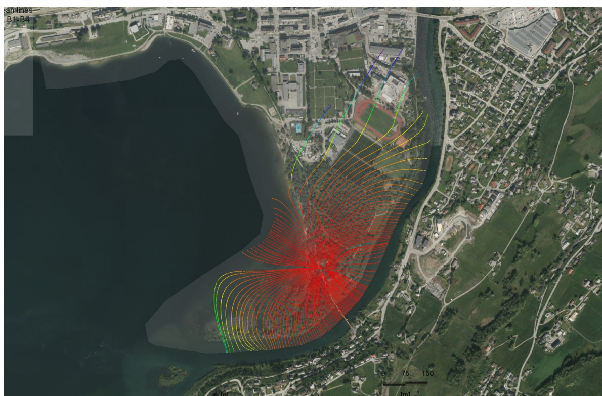
Figur 22: Figuren syner 60-døgns oppholdstid for vatnet i metta sone ved maksimalt uttaksrate.
