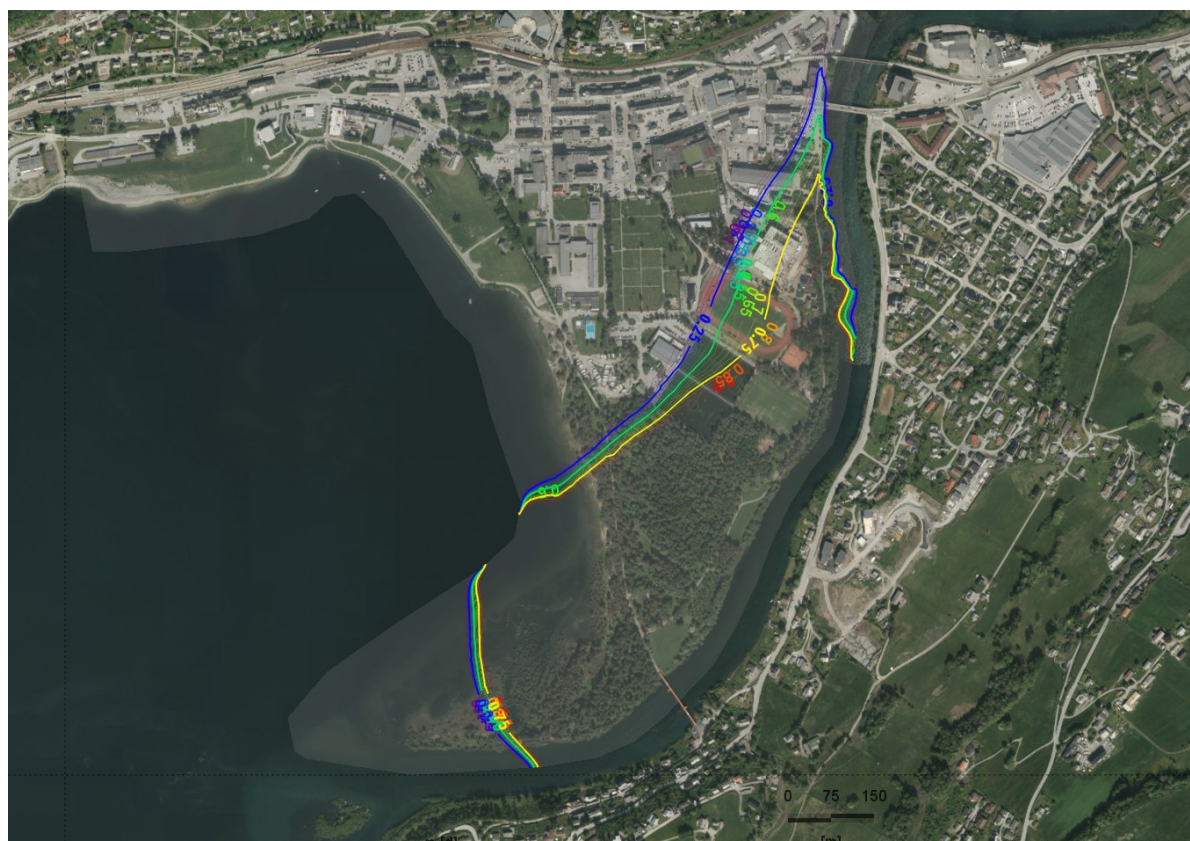
Figur 19: Figuren viser partikkelbanar (straumnigsbanar) simulert frå uttaksbrønn B1, B2 og B3.
