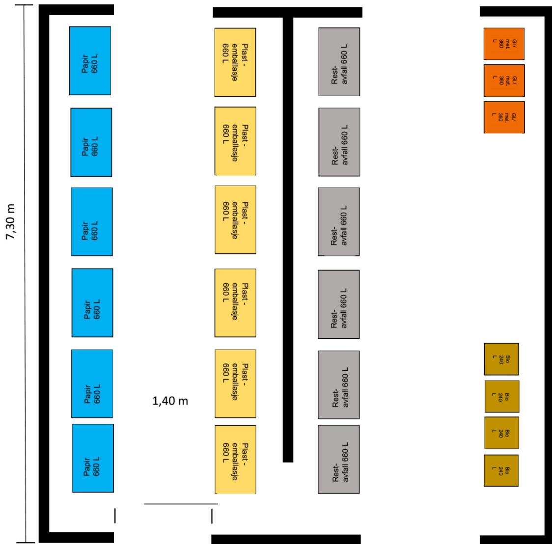
I staden for behaldar for plast kan det veljast eit strupestativ, som tek liten plass, men komprimerer opp til 8 gonger. Fulle sekker med plast kan lagrast i eigne skap, i avfallshuset eller avfallsrommet. Det er viktig at renovatørane har fri tilgang til plasten på tømmedag.
