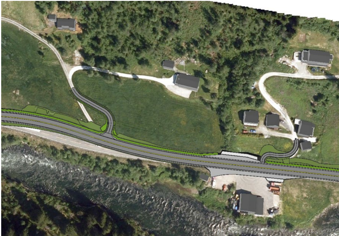
Figur 48 Planlagt situasjon ved omlagte avkjørsler ved Humlabrekko og Skjelviki. Her er det planlagt for busslommer og påstigningsplattformer (synt i lysast grå). Nord mot venstre. I plankartet er det lagt inn pil til jordbruksareal på nedsida veg, for å sikre adkomst. Eksisterande asfaltflate som ikkje vert nytta som veg vert fjerna og istandsett.
