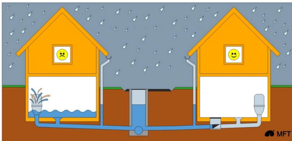
Tilbakeslag i avløpssystemet. Huset til venstre har ikke tilbakeslagsventil, og får kjelleren oversvømt. Huset til høyere har installert tilbakeslagsventil, og unngår dermed vann/kloakk i kjelleren.
