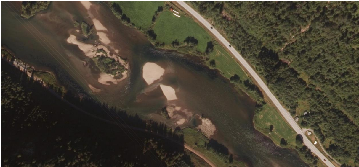
Figur 4. Morfodynamikk (endringer av elveløpet gjennom erosjon og sedimentasjon) i innløpet av «Skorvevatnet» 1949 (oppe) og 2020 (nede, norgebilder.no ). Strekningen er tendensiell transportbegrenset med opphoping av masser over tid ( norgebilder.no ).
