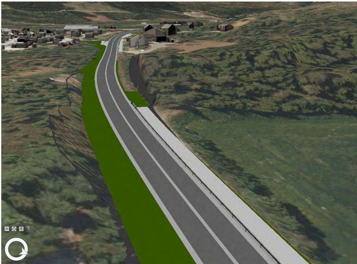
Figur 38 Dobbelsidige skjæringar ved profil 150
